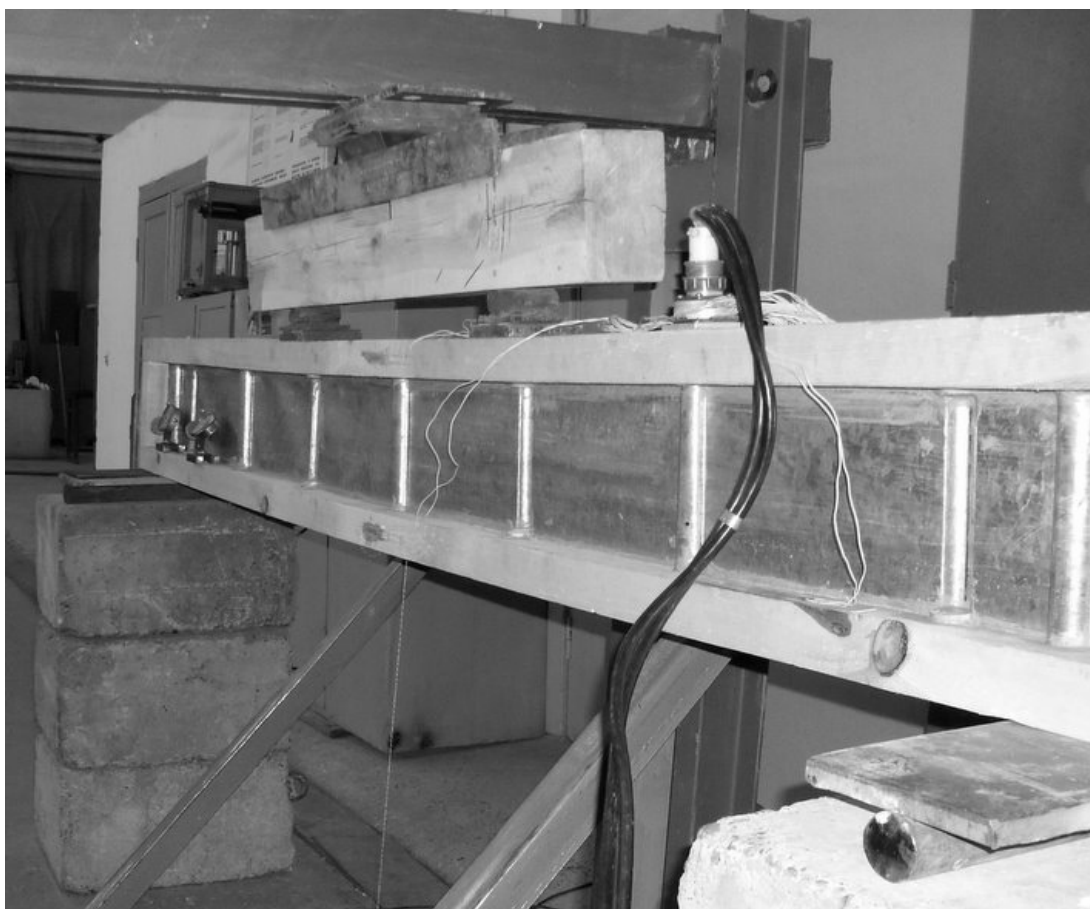
Рис. 2. Опытный образец балки в процессе испытания
