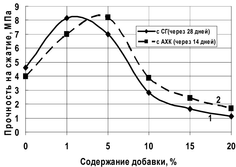
Рис. 3. Зависимость прочности ангидритовой композиции от содержания добавок: 1 – глиноземистая смесь, 2 – алюмохромовый катализатор
