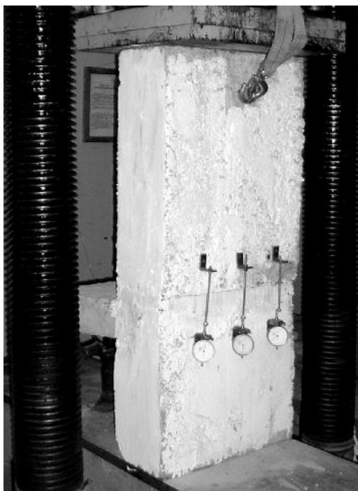
Рис. 2. Образец комбинированного стыка, смонтированный на прессе
