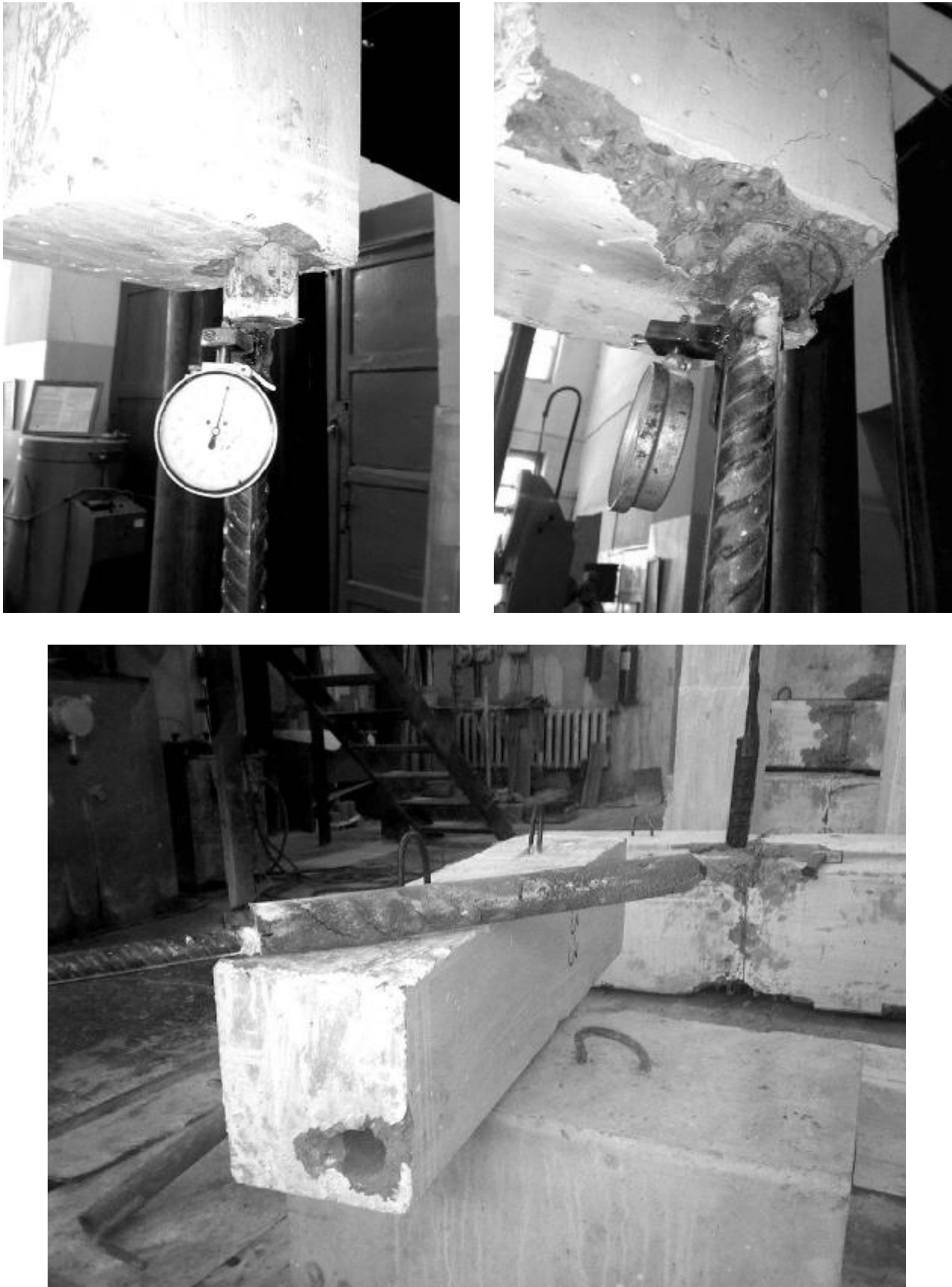
Рис. 5. Вид разрушенных образцов серии С3
