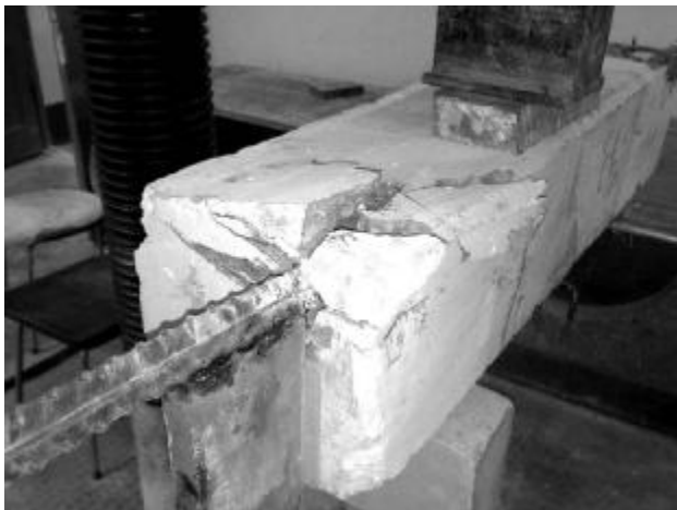
Рис. 3. Вид образцов после испытания серий С1 (а) и С2 (б)
