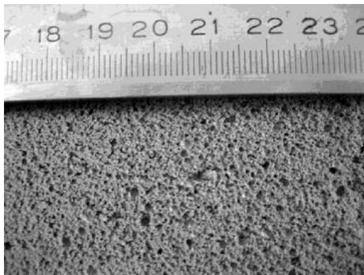
Рис. 6. Поровая структура пенобетона D 400, полученного из сухой смеси
