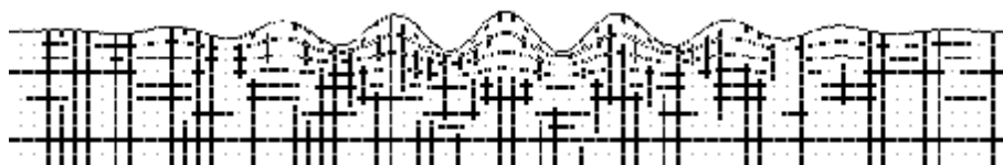
Рис. 4. Фрагмент средней части панели, с местной потерей устойчивости верхней сжатой обшивки
