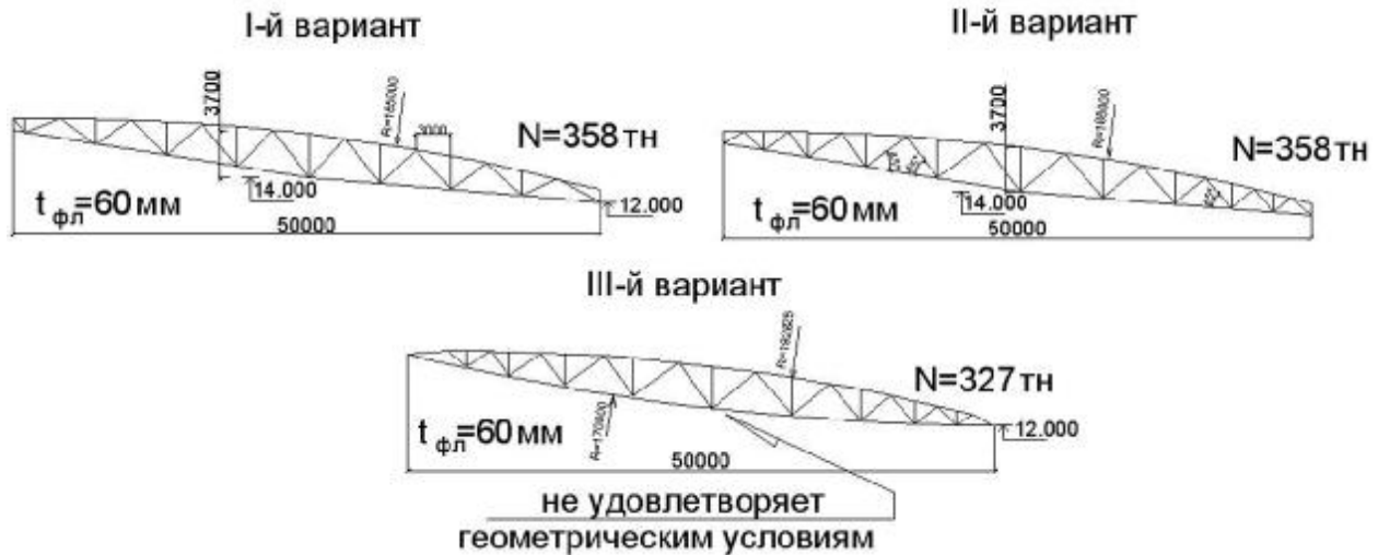
Рис. 2. Варианты конструктивных решений стропильных ферм пролетом 50 м
