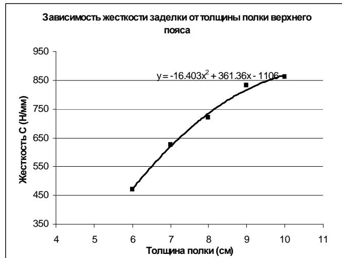
Рис. 7. Зависимость жесткости заделки от толщины полки верхнего пояса фермы
