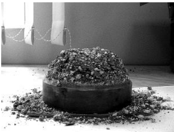
Рис.3. Увеличение объема образца квазипросадочного грунта после гашения грунтово-известковой смеси водой
