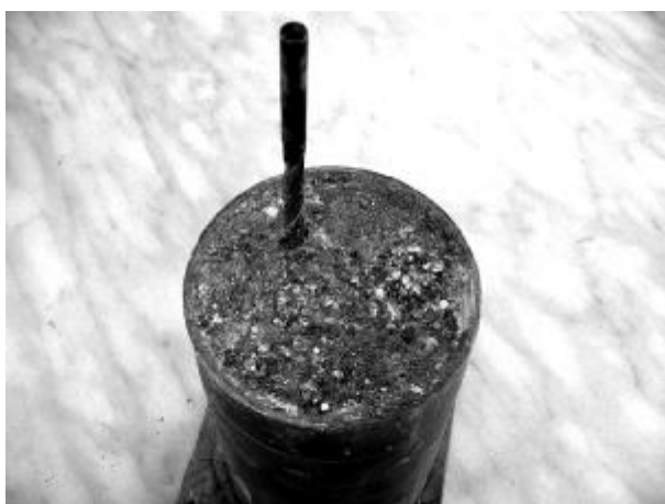
Рис. 5. Изготовление армоэлементов в образце квазипросадочного грунта: а) высверливание шурфов d=6 \text{ мм} ; б) армированный грунт
