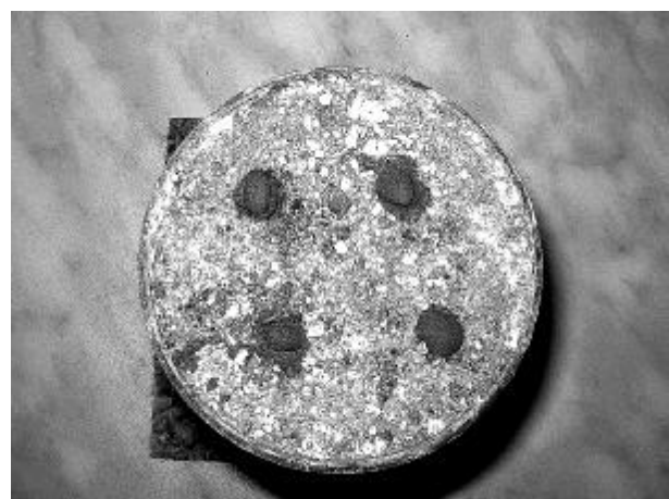
Рис. 5. Изготовление армоэлементов в образце квазипросадочного грунта: а) высверливание шурфов d=6 \text{ мм} ; б) армированный грунт
