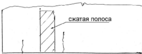
Рис. 3. Формирующаяся сжатая полоса в железобетонной стене
