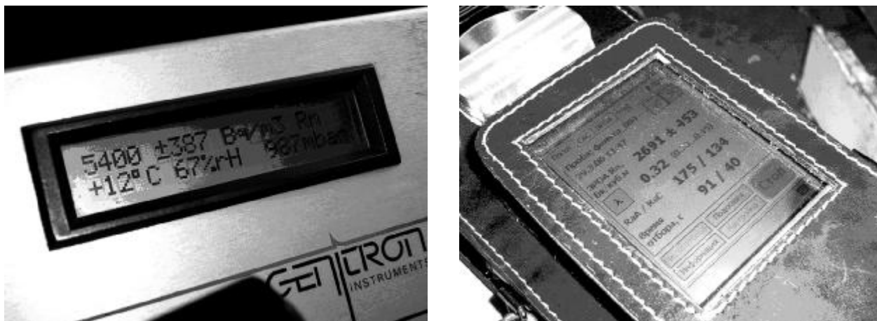
Рис. 7. Проведение сравнительных инструментальных измерений ЭРОА радона в воздухе жилого дома №42 по ул. Связи (29.03.2006 г.). AlphaGUARD PQ 2000 (слева), PAA-20 П2 «Поиск» (справа)
