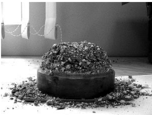
Рис.3. Увеличение объема образца квазипросадочного грунта после гашения грунтово-известковой смеси водой
