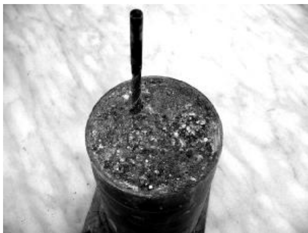
Рис. 5. Изготовление армозелентов в образце квазипросадочного грунта: а) высверливание шурфов d=6 \text{ мм} ; б) армированный грунт
