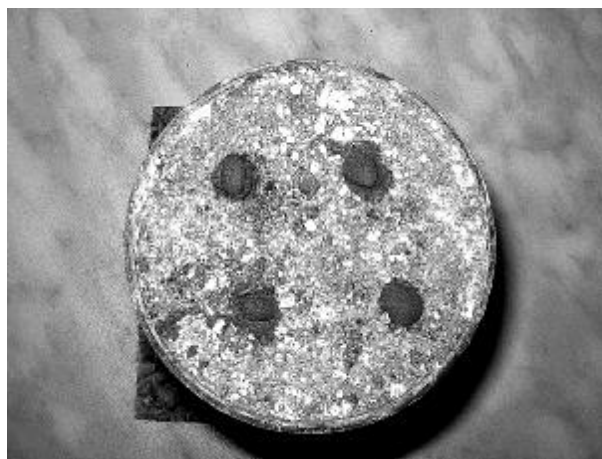
Рис. 5. Изготовление армозелентов в образце квазипросадочного грунта: а) высверливание шурфов d=6 \text{ мм} ; б) армированный грунт
