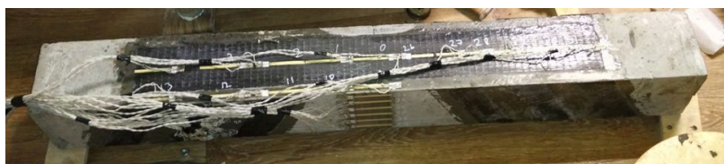
Рис. 7. Образец-балка усиленная СВА (иллюстрация авторов)
