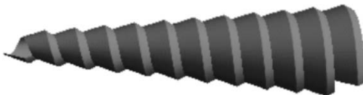
Рис. 5. Труба с винтовой поверхностью теплообмена, образованная движением треугольника в плоскости осевого сечения вдоль винтовой линии, расположенной на круговом конусе
