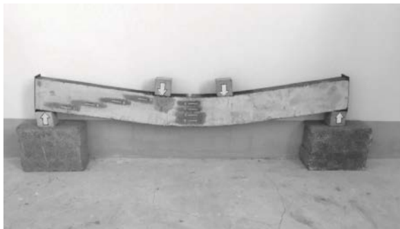
Рис. 9. Балка серии Б1 после испытаний
