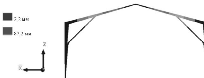
Рис. 16.3 Вертикальные перемещения элементов рамы по оси Z
