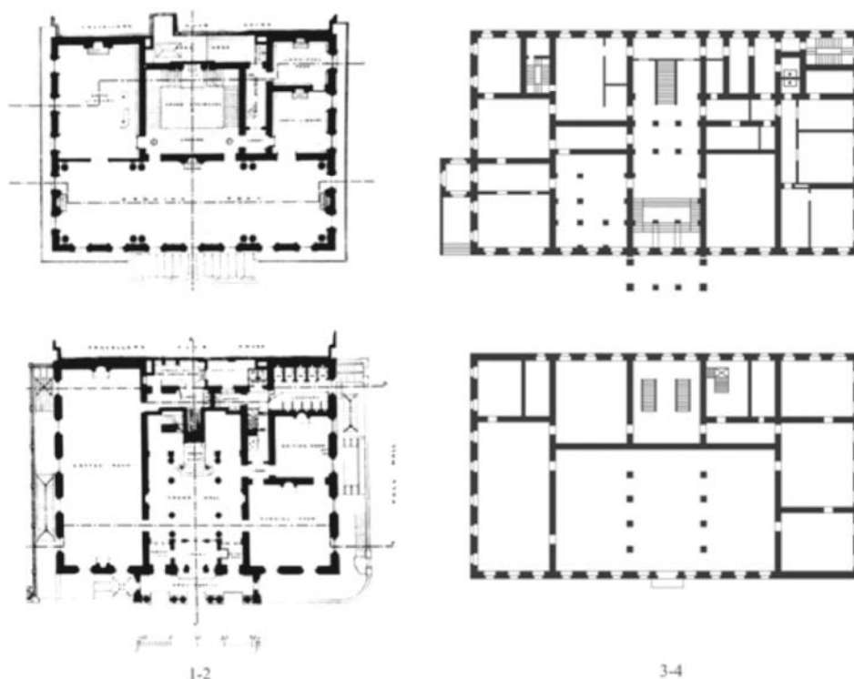
Рис. 2. Сравнение планировочных структур клубных зданий 1-2. Клуб «The Athenaeum» в Лондоне. 1828-1830 гг. Планы 1 и 2-го этажей 1882 г. [12]; 3-4. Дворянское собрание в Казани. 1844-1859 гг. План-схемы 1 и 2-го этажей конца XIX в. (схемы Надыровой Д.А.)
