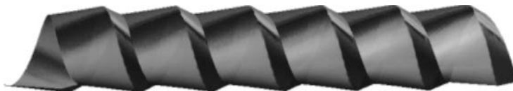
Рис. 2. Труба с винтовой поверхностью теплообмена, образованная движением треугольника в плоскости осевого сечения вдоль винтовой линии, расположенной на эллиптическом цилиндре
