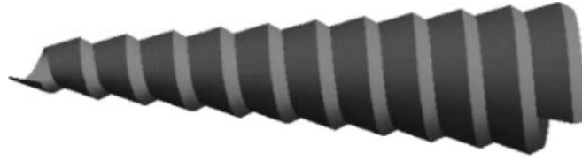
Рис. 4. Труба с винтовой поверхностью теплообмена, образованная движением треугольника в плоскости осевого сечения вдоль винтовой линии, расположенной на эллиптическом конусе
