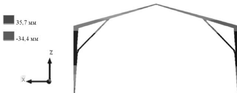
Рис. 15. Горизонтальные перемещения элементов рамы по оси X
