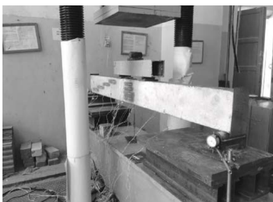
Рис. 7. Испытательный стенд с испытуемой балкой Рис. 8. Балка с наклеенными датчиками
