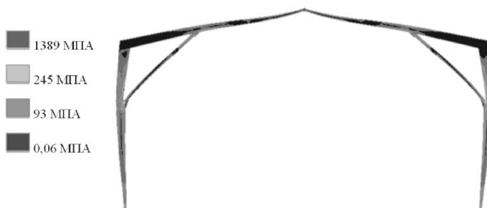
Рис. 10. Изополя эквивалентных напряжений
