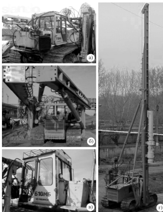
Рис. 2. Фотографии копровой установки СП-49: а, б, в – в транспортном положении; г – в рабочем положении
