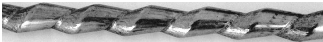
Рис. 6. Теплообменный элемент, полученный методом ротационного обжатия
