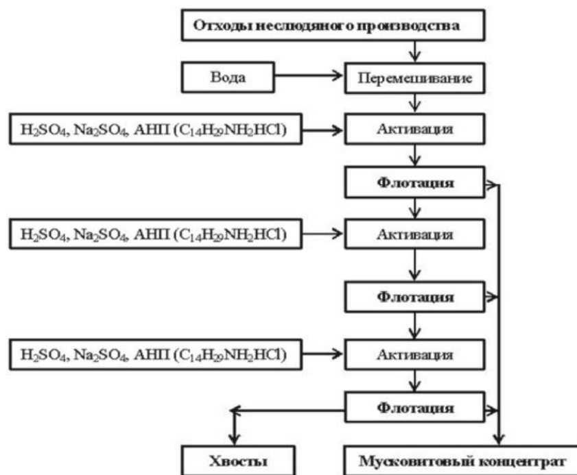
Рис. Схема флотации мелкоразмерного мусковита из отходов неслюдяного производства
