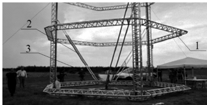
Рис. 3. Строительный 3D-принтер с дельтовидным приводом: 1 – каркас установки; 2 – тросы; 3 – печатающий оголовок
