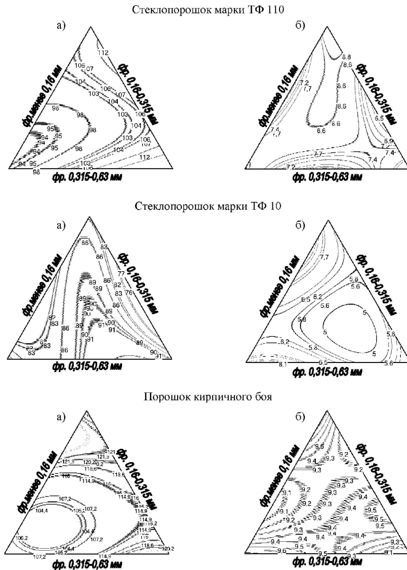
Рис. 5. Изолинии изменения предела прочности на сжатие (а) и модуля упругости (б) эпоксидных композитов в зависимости от гранулометрического состава различных наполнителей
