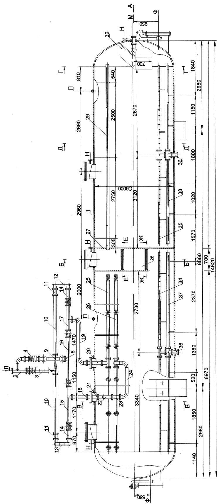
Рис. 2а. Конструктивное решение БГКО-1200 (разрез)
