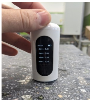
Рис. 2 – Схема установки Колориметра при измерении (иллюстрация авторов)
