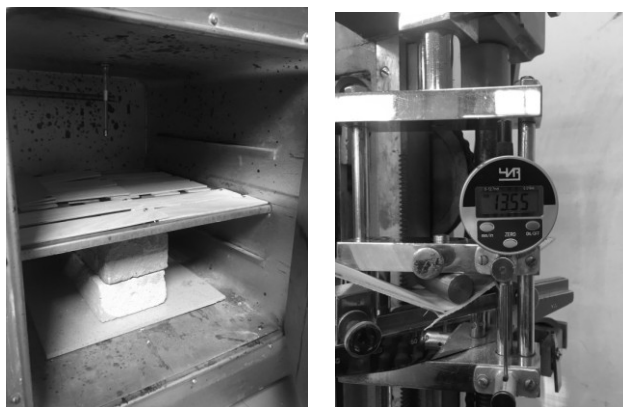
Рис. 2: Тепловое старение в лабораторной печи при температурах 40°С, 60°С, испытания на поперечный изгиб (иллюстрация авторов)
