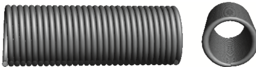
Рис. 2. Пружинно-витая труба, образованная путем намотки проволоки круглого сечения на эллиптический цилиндр
