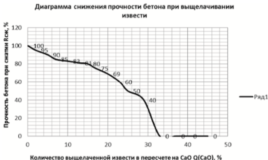
Рис. 6. По оси абсцисс отложено значение количества выщелоченной извести Q_{CaO} в пересчете на CaO, % по оси ординат – значение прочности бетона при сжатии R_{сж} , %
