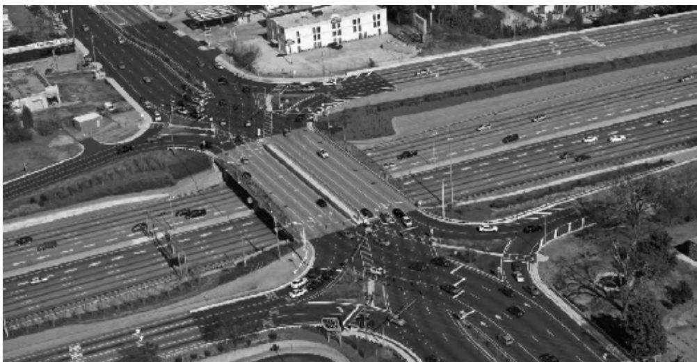
Рис. 3. Изменение сторон движения до и после путепровода
