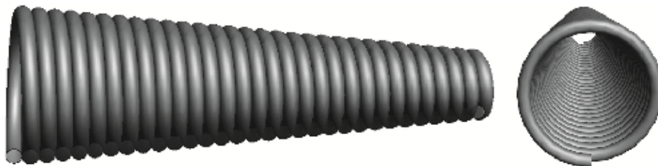
Рис. 5. Пружинно-витая труба, образованная путем намотки проволоки круглого сечения на круговой конус
