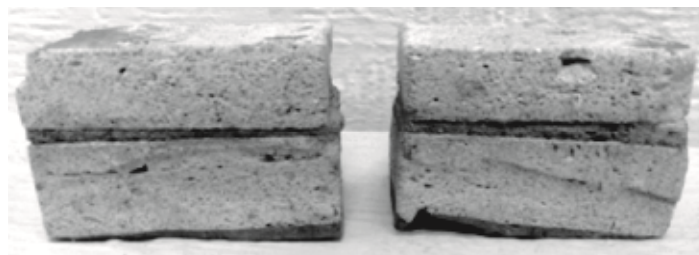
Рис. 7. Склеенные образцы штукатурного раствора
