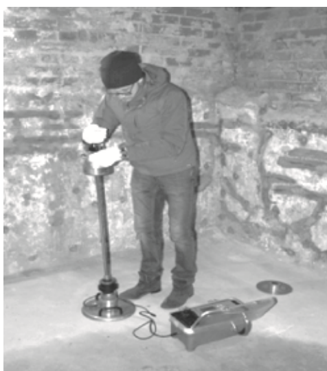
Рис. 3. Штамповые испытания прибором «ZORN»
