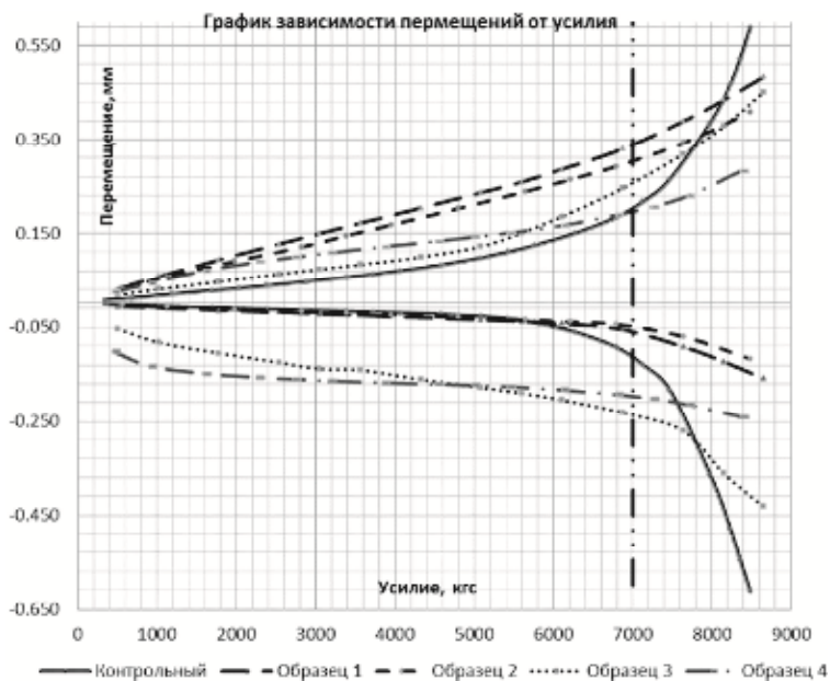
Рис. 6. Результаты моделирования в упругой стадии при t=4 мм (фрагмент 1)
