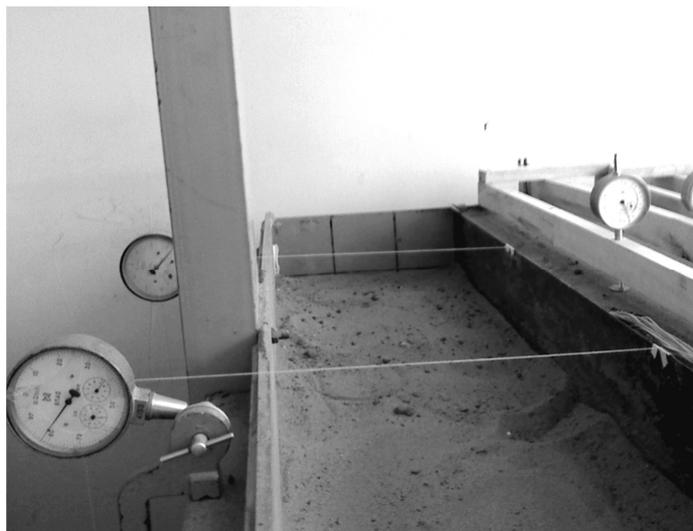
Рис. 1. Общий вид экспериментальной установки (объемный лоток) по завершении I этапа разработки грунта
