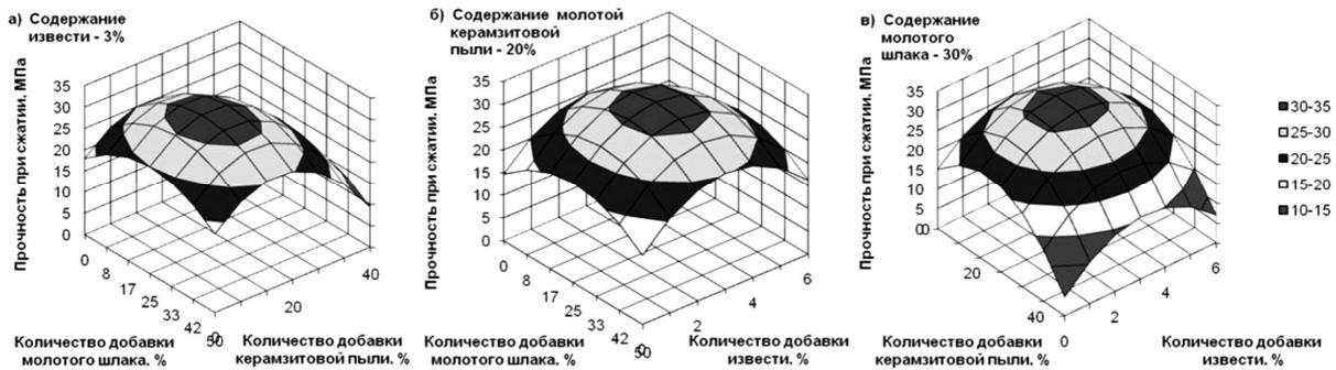
Рис. 1. Влияние компонентов комплексной гидравлической добавки: молотого доменного гранулированного шлака, керамзитовой пыли, извести (при содержании суперпластификатора Полипласт СП-1 – 0,5 % от массы вяжущего) на прочность при сжатии искусственного камня на основе композиционного гипсового вяжущего
