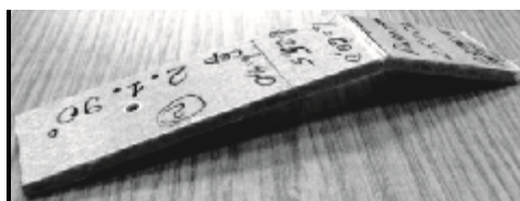
Рис. 3. Вид разрушенного образца № 1
