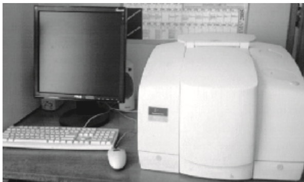
Рис. 1. Спектрофотометр PerKin ElmerFT-IR Spectrometer модель Spectrum 65
