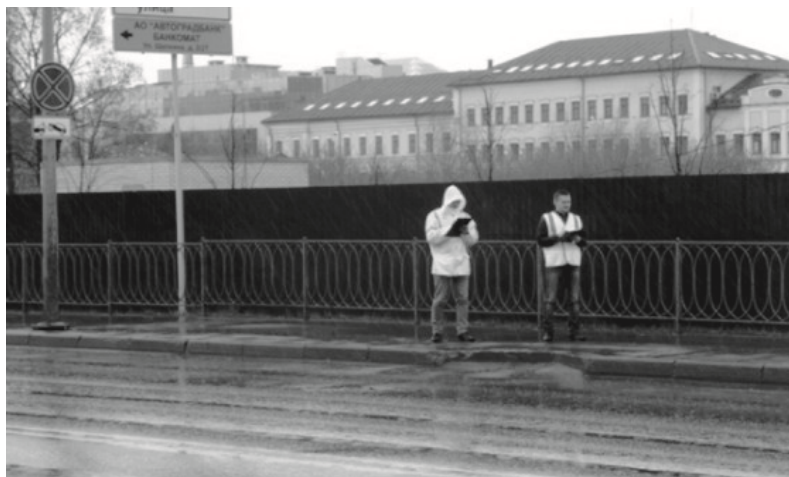
Рис. 2. Определение интенсивности движения и состава потока на ул. Тихомирнова непосредственными наблюдениями
