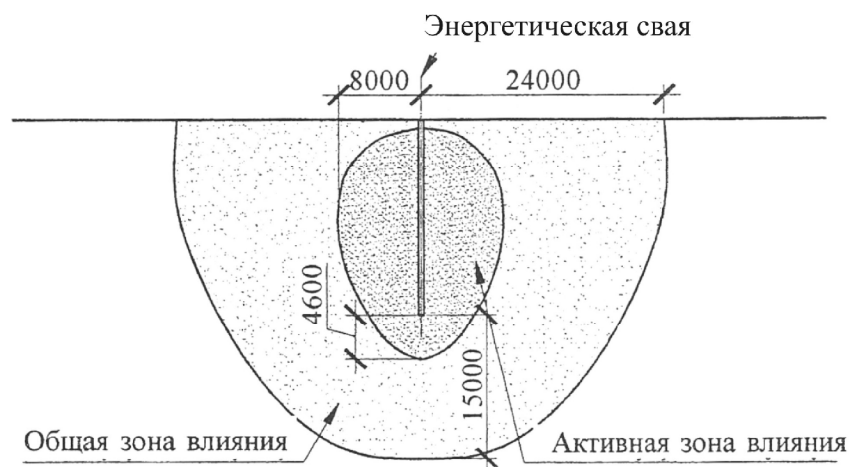
Рис. 7. Пример определения зон влияния энергетической буронабивной сваи глубиной 20 м и диаметром 0,5 м
