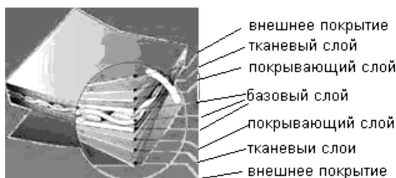
Рис. 3. Конструкция материала для мягких резервуаров фирмы «Laboronne-CITAF»
