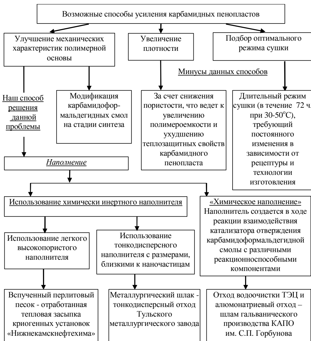
Рис. 1. Блок-схема возможных способов усиления карбамидных пенопластов
