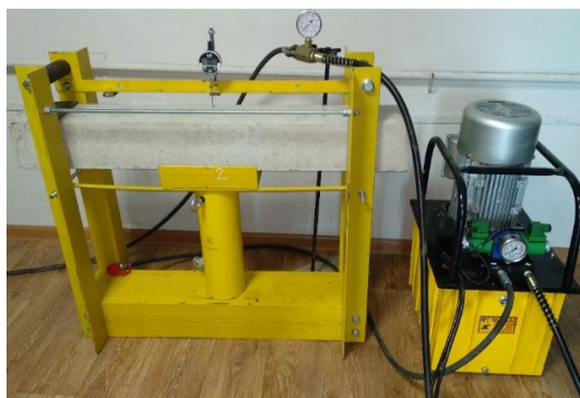
Рис. 2. Проведение испытаний на балках (иллюстрация авторов) Fig. 2. Testing on beams (illustration by the authors)
