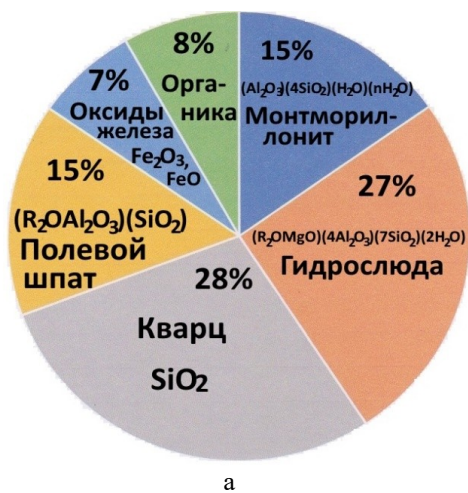
Рис. 2. Минеральный состав сырьевых компонентов: а) – кыштырлинская глина; б) – металлургический шлак (иллюстрация авторов) Fig. 2. Mineral composition of raw materials: а) – Kyshtyrli clay; б) – metallurgical slag (illustration by the author)
