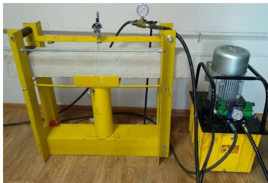
Рис. 2. Проведение испытаний на балках (иллюстрация авторов) Fig. 2. Testing on beams (illustration by the authors)
