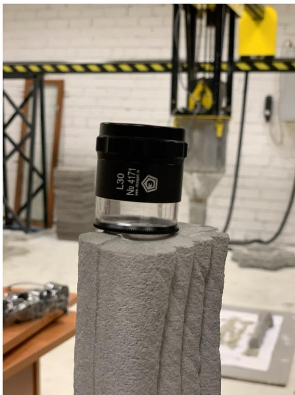
Рис. 1. Фиксация дефектов при помощи увеличительной лупы (иллюстрация авторов)
