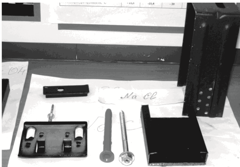
Рис. 2. Образцы фасадной системы после испытания в соляной среде
